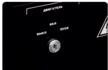
(c) Установите выключатель в положение «ВЫКЛ».
