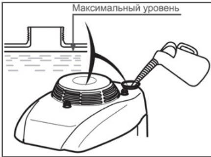
Рис. 10 Максимальный уровень топлива в топливном баке
