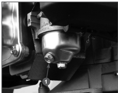
Рис. 14 Слив топлива из карбюратора
