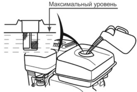
Рис. 5 Максимальный уровень топлива в топливном баке
