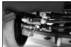
Fig. 8 Robinet de régulation du débit d'eau complètement ouvert.
