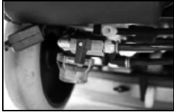
Abb. 9 Wasserregulierungshahn vollständig geschlossen
