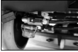
Abb. 8 Wasserregulierungshahn vollständig geöffnet
