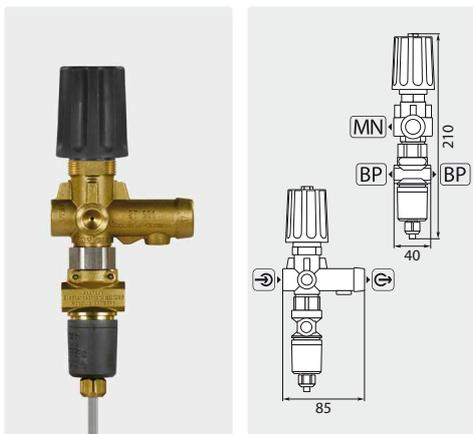
☉ = Вход 3/8" IG. ☉ = Выход 3/8" IG. BP = Вуypass 1/4" IG. MN = Манометр 1/4" IG. Перепускной вентиль с 4-проводным микровыключателем (IP65) и кабелем 1.200 мм. Макс. 250 bar / 80 °C
