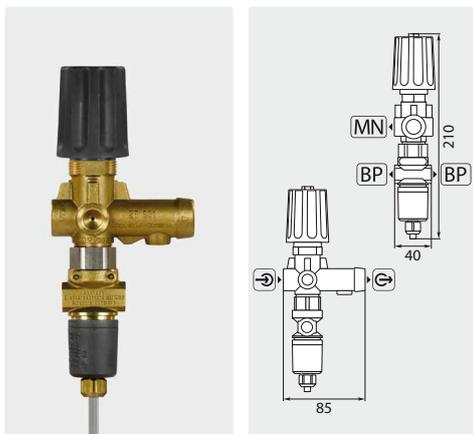
☉ = Вход 3/8" IG. ☉ = Выход 3/8" IG. BP = Вуypass 1/4" IG. MN = Манометр 1/4" IG. Перепускной вентиль с 3-проводным микровыключателем (IP65) с кабелем 1.200 мм. Макс. 250 bar / 80 °C
